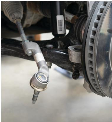
Fig. 2: Tie rod end link.
