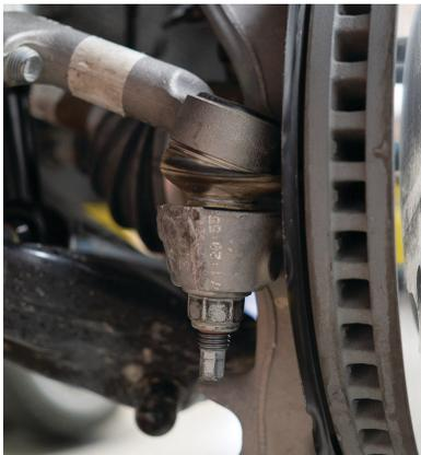
Fig. 10: Tie rod end link.
