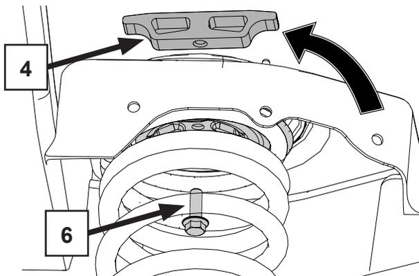
POSITION UPPER EXTRUSION ONTO UPPER SPRING PERCH AND INSTALL PROVIDED BOLT
