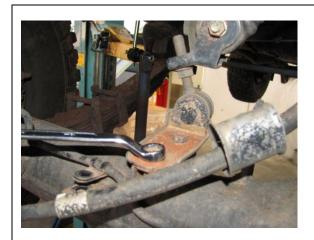
1. REMOVE THE BRAKE PROPORTIONING VALVE BRACKET AS SHOWN.
