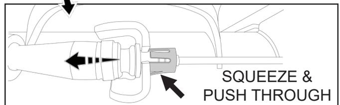
**ROUTE E-BRAKE CABLES UNDER CROSS MEMBER AND FUEL LINES.**
