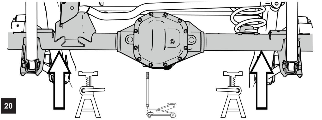
**REMOVE E-BRAKE CABLE BRACKET AND DISCARD**
