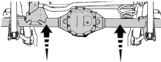
MAKE SURE TO FULLY SEAT THE SPRINGS INTO THE UPPER SPRING ISOLATOR
