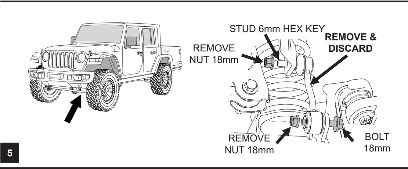
**REMOVE AND DISCARD BRAKE LINE BRACKETS FROM LOWER CONTROL ARMS**
