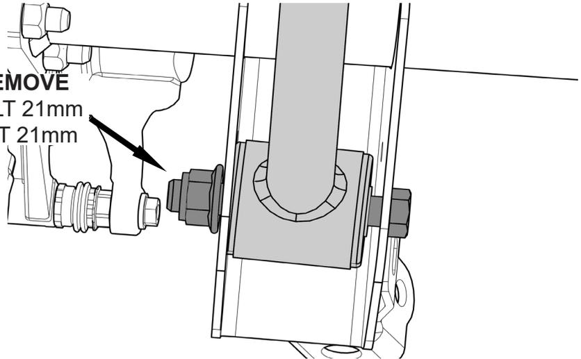
INSTALL THE FIXED END OF THE ALPINE CONTROL ARM TO THE FRAME WITH THE STICKER FACING OUT. LEAVE FINGER TIGHT.
